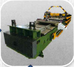
涨管工程 涨管机
