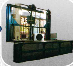
检漏工程 气密试验装置
